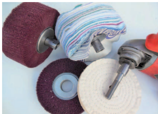
Upnutí leštícího kotouče pomocí redukce do leštičky FLEX
