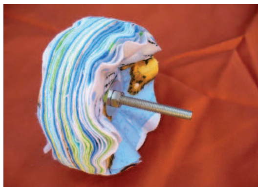
Upnutí leštícího kotouče pomocí redukce do leštičky FLEX
