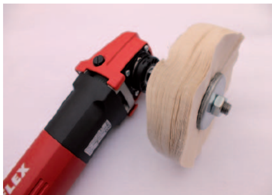
Upnutí leštícího kotouče pomocí redukce do leštičky FLEX
