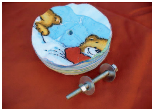
Upnutí leštícího kotouče pomocí redukce do leštičky FLEX
